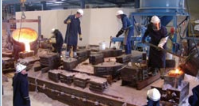
A typical 5 tonne pour
